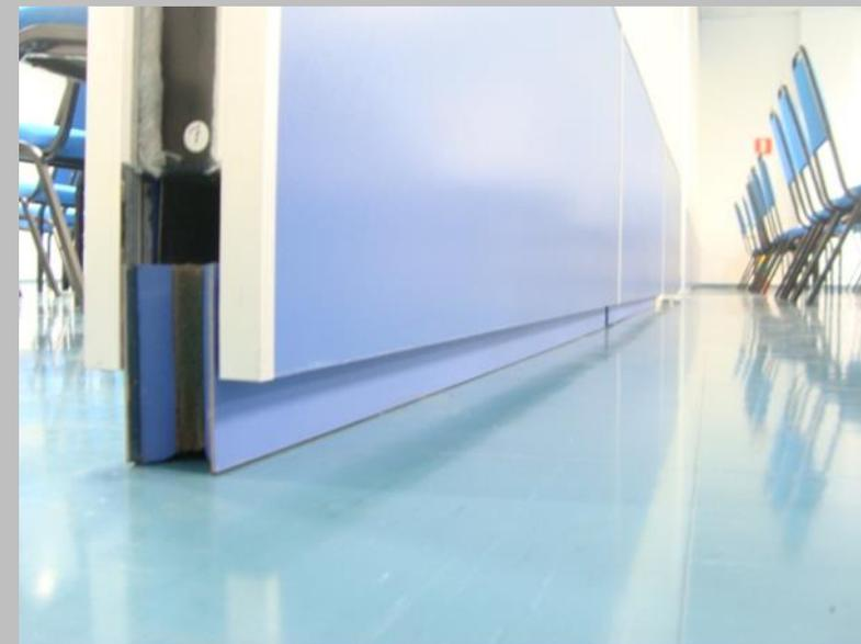
*Vedação Horizontal – Telescópicos em alumínio são acionados através de uma manivela, travando simultaneamente o painel entre o piso e o trilho. Curso de ajuste padrão de 35mm.*
