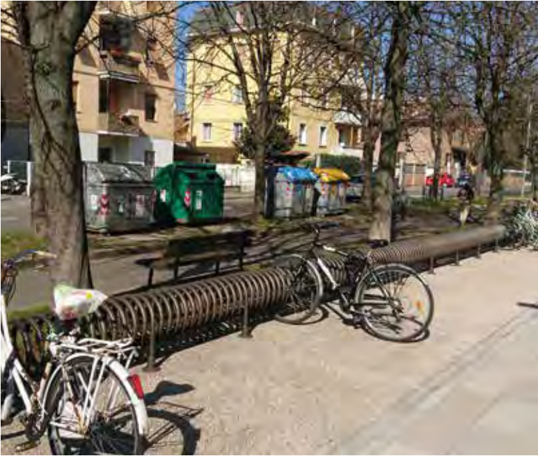
Bicicletário em tubo de aço carbono com tratamento anticorrosivo em formato de espiral contínua com bases também em aço carbono com tratamento anticorrosivo.
